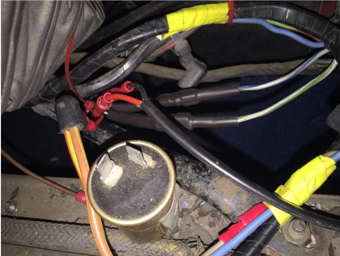
Abbildung 5: Altes Warnblinkrelais im Vordergrund, dahinter die geänderte Verdrahtung
